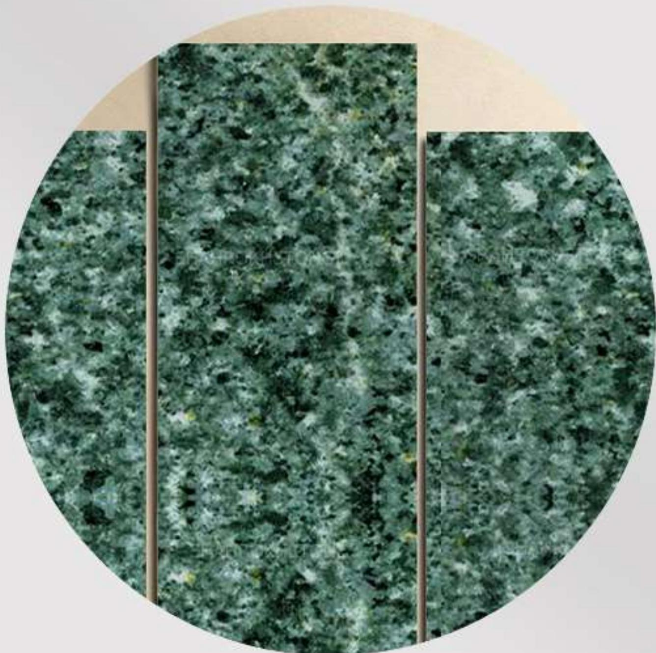
این سنگ در سنگفرش فضاهای باز به صورت فلیم شده و کوپیک نیز کار می شود. این سنگ ساب پذیری خوب و جذب آب پایینی دارد. سنگ گرانیت سبز اردستان بدلیل رنگ سبز یکنواخت و مقاومت بالا و قیمت مناسب نسبت سنگ های مشابه مصرف زیادی در ساختمان سازی دارد.
